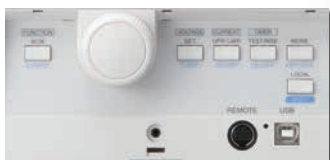
▲フロントパネルの保護用カバーを 取り外したところ
