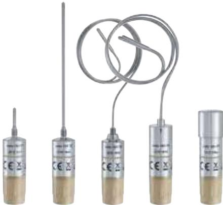
耐熱・耐圧データロガー testo 191 シリーズは、4種類の温度ロガーと1種類の圧力ロガーで構成されています。食品・飲料・製薬業界で求められる、レトルト食品、飲料缶、缶詰の殺菌工程、高圧蒸気滅菌、凍結乾燥プロセスの温度・圧力モニタリングに最適なロガーです。
