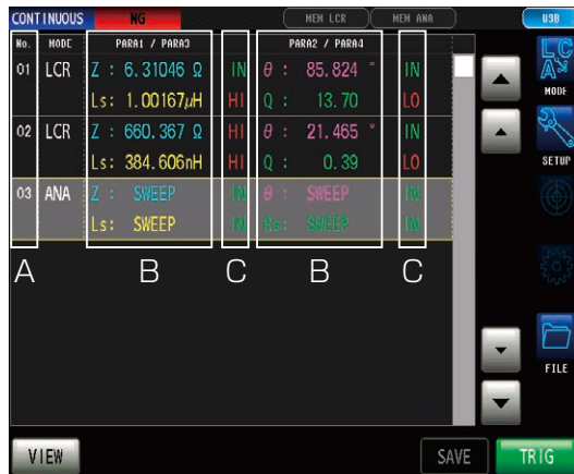
A 連続測定に設定したパネル No. / B 測定値 / C 各パラメータの判定結果
