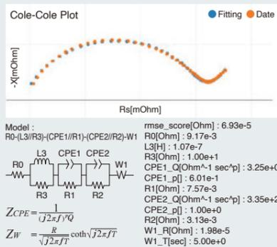
定義されたモデルを使用し、バッテリーのインピーダンスを解析します。ファイルを読み込むだけで、自動で解析結果を表示します。
