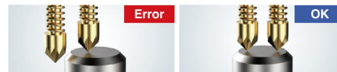
正確な測定には正確なプロービングが必要です。HIOKI のバッテリーテスターは、プローブの接触状態を監視する機能が搭載されており、信頼性の高い検査を実現できます。
