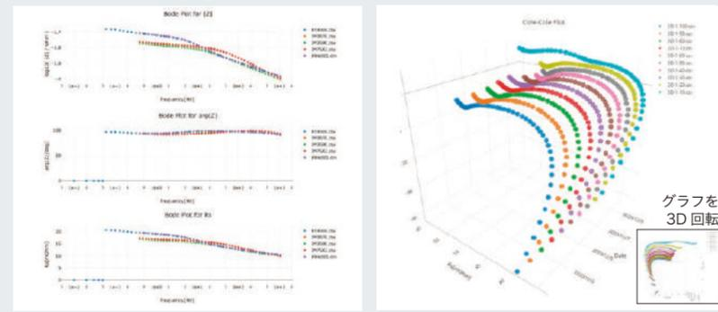
Cole-Cole プロットと同時に Bode プロットを作成します。Bode プロットにより、位相特性を把握することができます。
