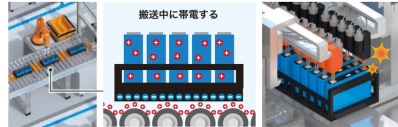
生産ラインでは、コンベアでの搬送中などに電池が帯電します。電池にプローブをコンタクトすると、測定器に静電気が印加され、測定器の故障に繋がります。BT3561A, BT3562A, BT3563A は、接触 ±30 kV の静電気に耐える設計です\*。静電気による故障を防ぎ、生産ラインのダウンタイムを削減できます。
