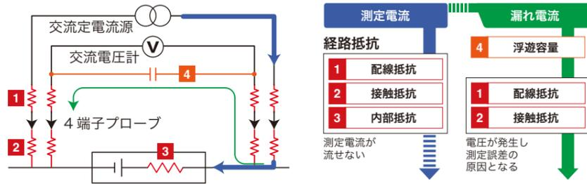
「経路抵抗」が大きいと、電流エラーや測定誤差が発生し、正確な検査ができなくなります。
