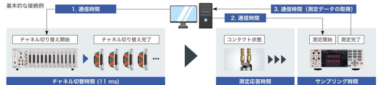
タクトタイムの計算  $\text{トータル時間} = (\text{通信時間} + \text{チャンネル切替時間} + \text{測定応答時間} + \text{サンプルング時間}) \times \text{チャンネル数}$
