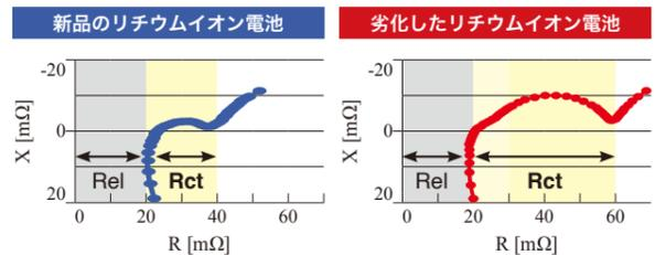
Rel: 電解液抵抗 Rct: 反応抵抗
