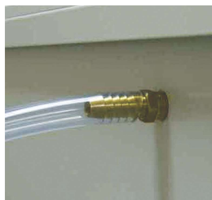
集塵効率測定用ポートへのノズル取り付け例
