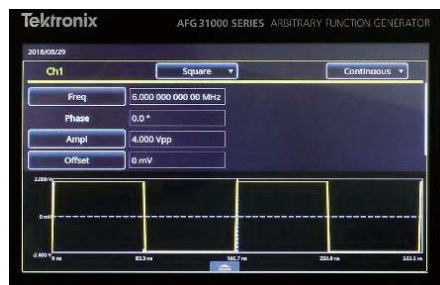
AFG31000でInstaView オフ時のスクリーン 設定した方形波を表示しており、実際のDUTでの波形とは異なっている
