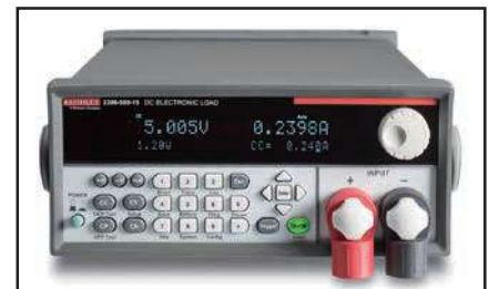
2380-500-15型の前面パネル。入力端子に安全カバーが付いている
