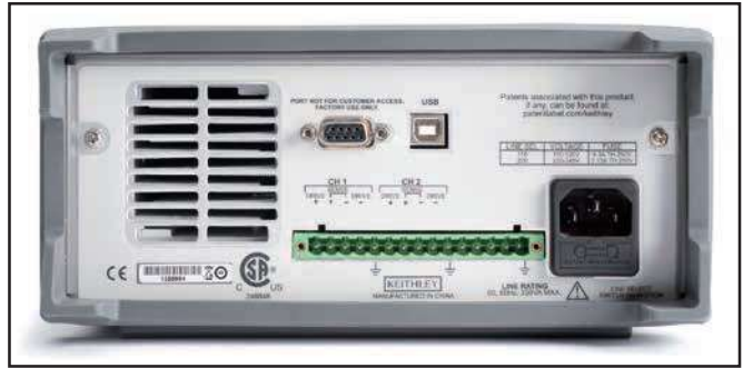
2220-30-1型の後部パネル。2220G-30-1型はGPIBコネクタも装備
