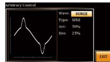
商用電源のピーク過電圧をシミュレート
