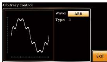
実際の出力電力波形をシミュレートします。
