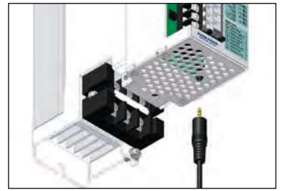
ローダ通信コネクタ接続図 PAC28シリーズ 30A品の場合
