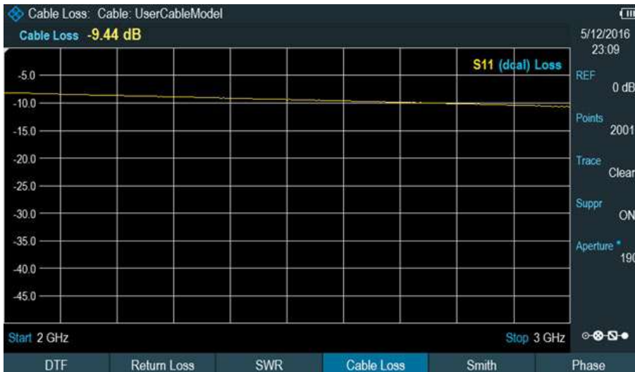
1ポートケーブル損失測定
