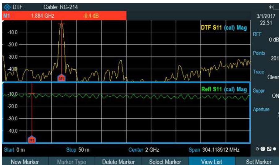
障害位置測定とリターンロス：コンバイン測定
