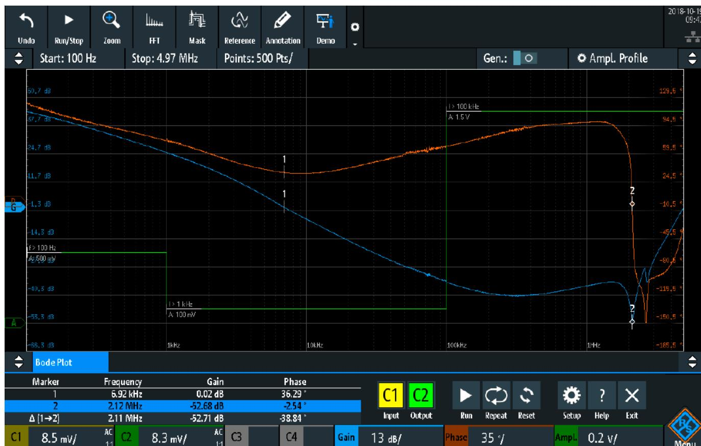
DUTのノイズ動作を抑制するため、ジェネレーター信号の振幅出力レベルを測定中に変更可能
