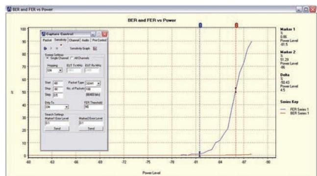
自動感度サーチ測定により、受信機へのパワー減衰に伴う、EUTのFER(フレーム誤り率)/BER(ビット誤り率)性能が表示されます。テストは、サポートされているBasic RateとEDRパケットのすべての種類に対して実施できます。
