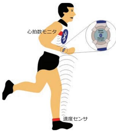
Bluetoothデバイスには、Basic Rate、EDR、Bluetooth low energy機能を1つのチップに統合したデュアルモードデバイスと、Bluetooth low energyのみをサポートするシングルモードデバイスの2種類があります。
