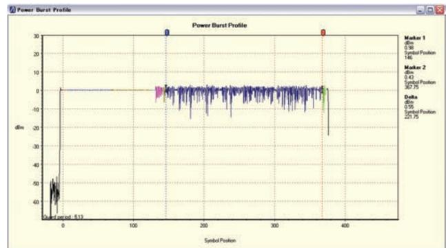
3-DH1パケットの出力バーストプロファイルパケットの各要素を色分けで識別します(たとえば、プリアンプルを赤、アクセスコードを薄青色、PSKペイロードを濃青色)。
