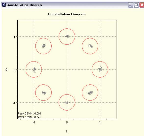
BlueSuite Pro3は、すべてのペイロード表示記号、またはユーザ定義の50  $\mu$ sブロックのIQコンスタレーションパターンを表示します。リミットサークルは、 $\pi/4$ DQPSK、または8DPSKの変調基準に対するBluetoothコア仕様の規格値に初期設定されています。
