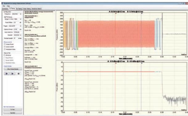
この図に示す [Tx Testing] タブを使用して、EUTからのデータ送信を行う際の条件を設定できます。
