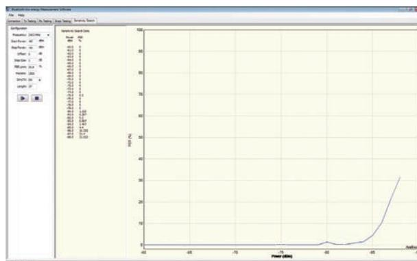
HCIインタフェースを備えるBluetooth low energyデバイスの測定は、[Script Testing] タブから完全に自動化することができます。必要なテストケースの選択と設定を行い、[>] をクリックすることで、スクリプトが実行されます。テスト結果は、ユーザによる印刷または保存が可能なレポートの形で表示されます。
