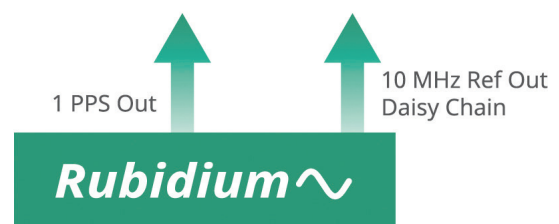
図2 ルビジウム原子クロックリファレンス
