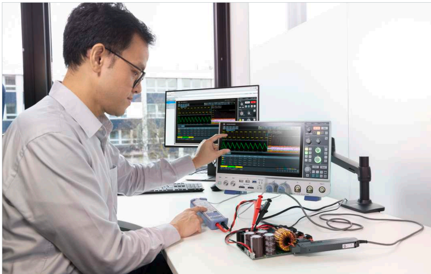
高電圧差動プローブによるスイッチング電源の解析。
