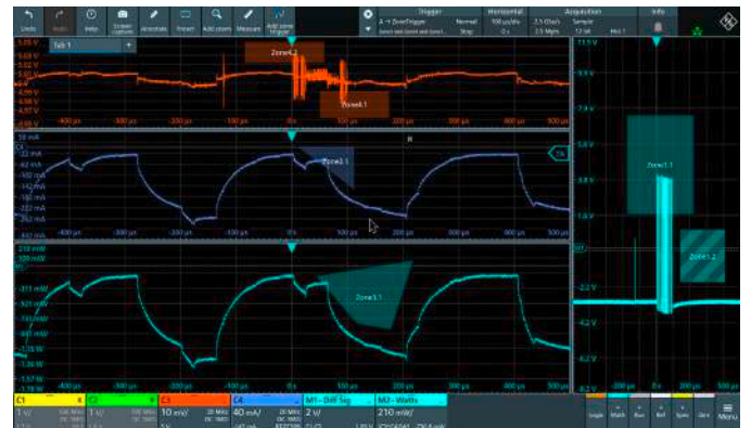
パワーレールの測定にゾーントリガを用いて、RF送信中の電力消費イベントを分離
