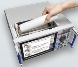
ゴムローラとサーマルヘッドの間に記録紙を通す作業を不要にしました。投げ込む感覚でセットアップができます。
