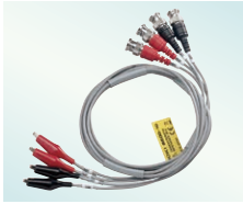
4端子プローブ9500-10 ケーブル長1 m, DC ~ 200 kHz, 特性インピーダンス 50 Ω 4端子対構造, 測定可能端子直径: 0.3 ~ 2 mm
