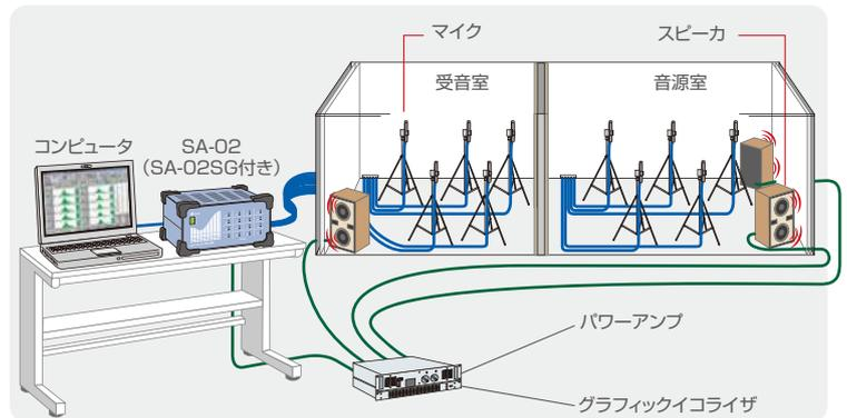
●JISに基づいた建築物、建築部材の遮音性能測定用。残響時間、床衝撃音・低減量、空気音、残響室法吸音率の各カテゴリの測定、評価を行う
