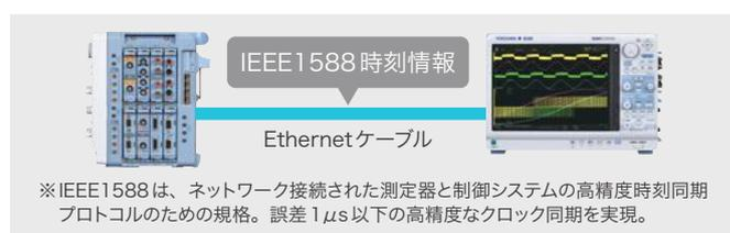
※IEEE1588は、ネットワーク接続された測定器と制御システムの高精度時刻同期プロトコルのための規格。誤差1 $\mu$ s以下の高精度なクロック同期を実現。
