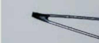
先端はんだコート (S) 熱電対先端と温度測定対象物のはんだ付に
