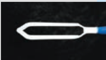
絶縁コーティング (IC) 温度測定箇所のショートカットの防止
