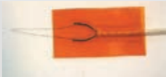
カプトンテープ補強 (R) 応答性そのままに先端部の強度向上
