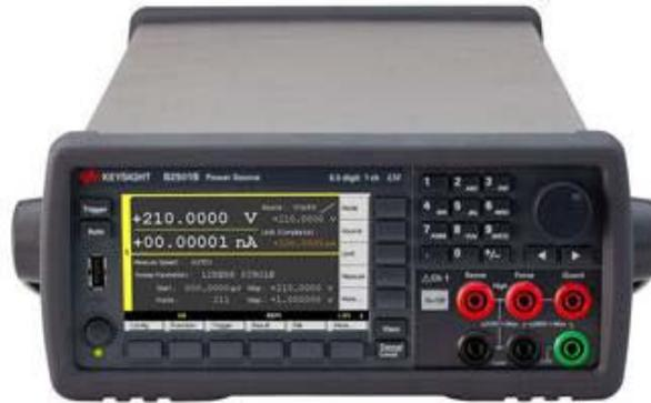
プレジジョンソース/メジャーユニット 電圧出力：±200mV～±200V
