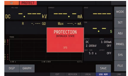
インターロックの作動による出力遮断
