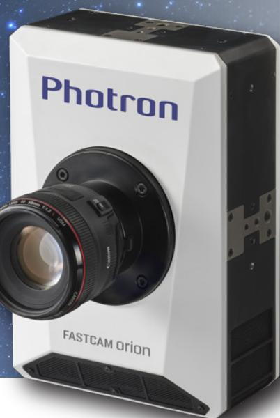
「FASTCAM Orion S40」は裏面照射型イメージセンサーおよび、CDS機能を搭載した最新センサー技術を用いることで超低ノイズを実現した高画質モデルです。さらに、100万画素(1024×1024)で37,500fpsの撮影が可能で、従来モデル\*比約2倍の高速撮影性能も両立した新しいハイスピードカメラです。
