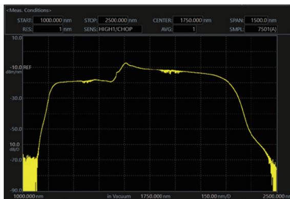
2 $\mu$ m帯スーパー・コンティニウム光源の測定例
