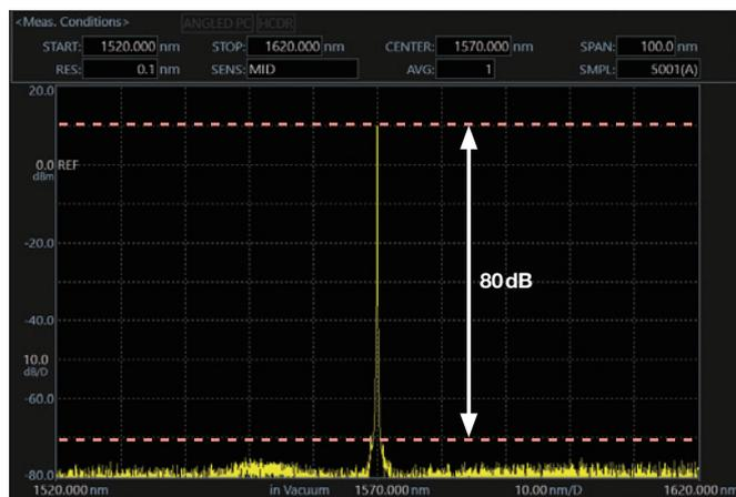
図2 迷光抑圧比の例 (AQ6370E-20)
