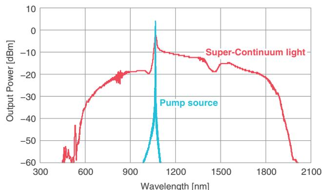
スーパー・コンティニウム光源の測定例 (AQ6374E+AQ6375E)
