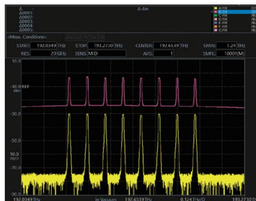
図2. 2種類の測定波形の表示例 (AQ6370E)
