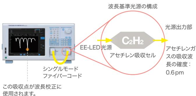
波長校正用光源はAQ6370E(工場出荷時オプション)とAQ6374E、AQ6375E、AQ6376E、AQ6377Eに搭載しています。
