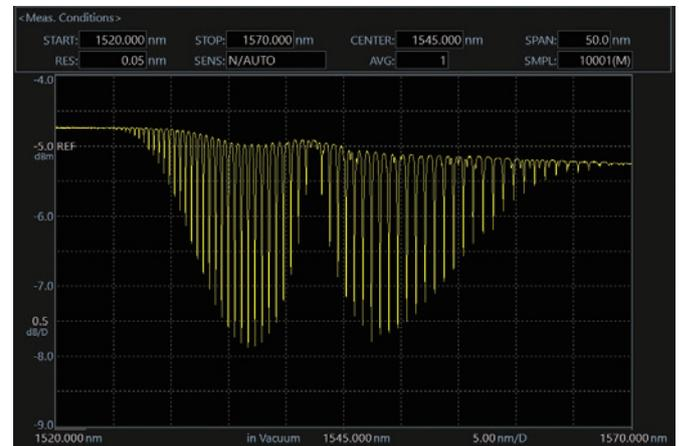
シアン化水素 H<sub>13</sub>C<sub>14</sub>N の光吸収スペクトル測定例 (AQ6375E)
