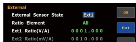
2系統の外部電流センサー入力
