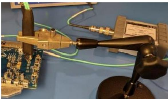
プロブは、プロブホルダーと組み合わせても使用する事で、確実に再現性の高いコンタクトを得る事ができます。
