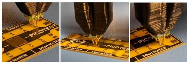
プロブの影響を取り除くため、付属の校正基板を用いて VNA のキャリブレーションを実施します。
