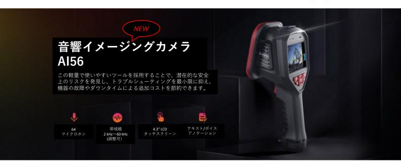
AI56 音響イメージング カメラは、プロフェッショナルな音源特定用カメラです。 64 個の低ノイズ MEMS マイクと 2 kHz から 60 kHz までの調整可能な帯域幅を備えており、産業環境での空気や蒸気の漏れの位置を特定したり、高電圧システムの部分放電の検出を簡単に効果的に行うことができます。 大型の 4.3 インチ LCD タッチ スクリーンを採用し、問題の箇所をすばやく見つけることができます。最大検出距離は 100 メートルで、安全な距離を保って検査することができます。軽量で取り扱いも簡単なAI56を使用して、設備機器の故障やダウンタイムによる余分なコストを節約できます。
