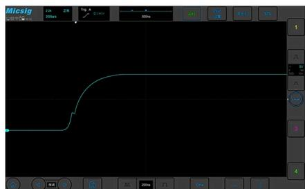
SigOFITプローブは、100MHzで128dB、1GHzで100dBを超える高いコモンモード除去比(CMRR)を持ち信号を忠実に測定可能です。
