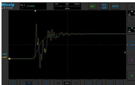
SiCやGaNのようなデバイスは、高エネルギーの高調波を含む高電圧を数ナノ秒でスイッチングします。SigOFITは最大周波数帯域においても100dB以上のCMRRを有し、高周波コモンモードノイズによる影響を抑制します。
