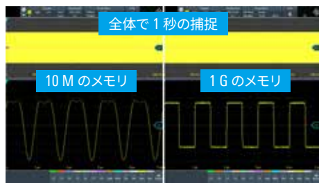
大容量メモリにより、フルサンプリングレートでも長時間の捕捉が可能
